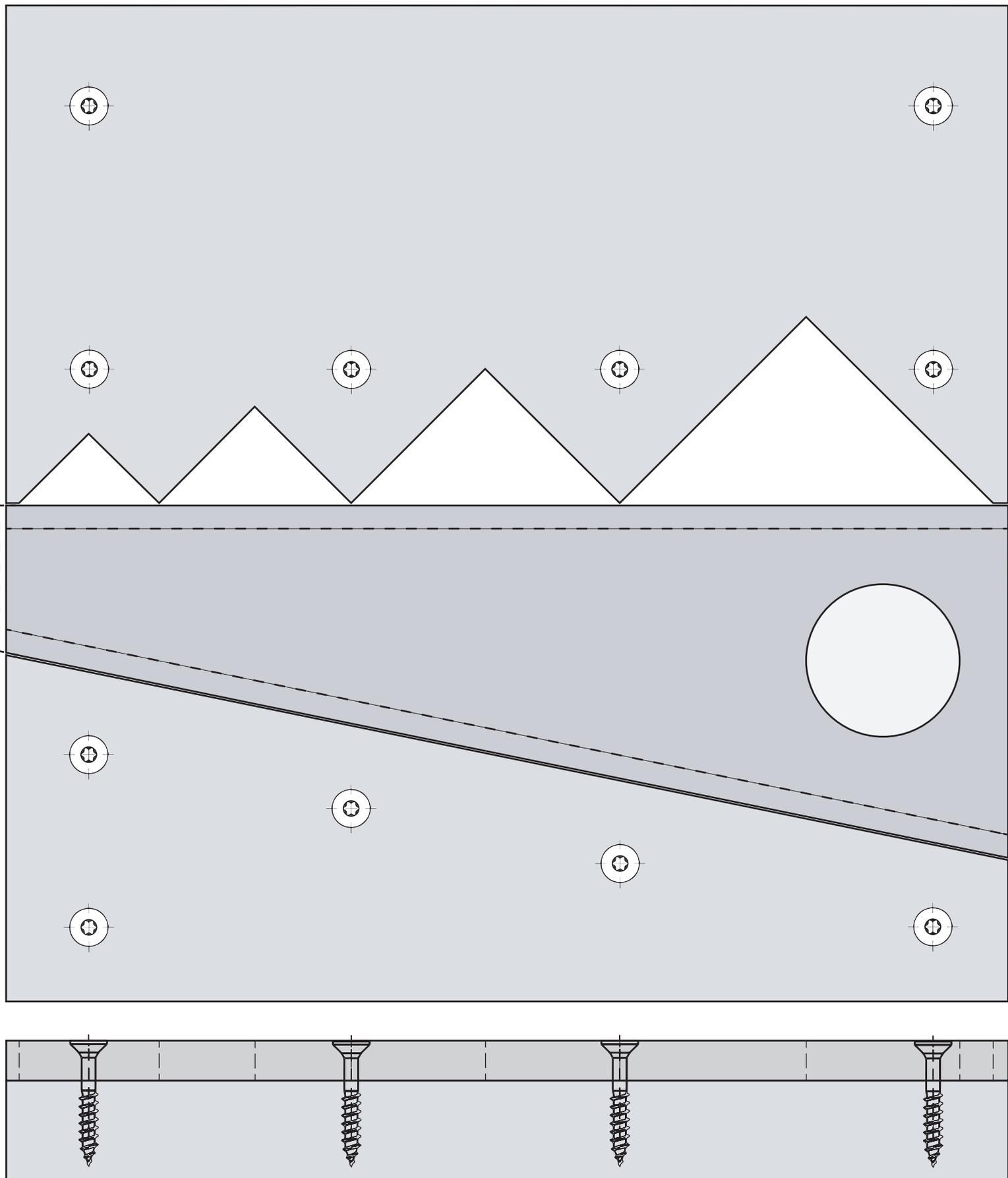
Die Einspannvorrichtung besteht aus einer Grundplatte und einem dreiteiligen Klemmsystem. Das bewegliche Keilstück fixiert Kreisscheiben unterschiedlicher Durchmesser in den Aussparungen und zieht unter der Drehwirkung des Bohrens fest. Auch kleine rechteckige Holzstücke lassen sich damit einspannen.
