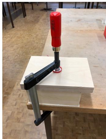
Es gibt verschiedene Varianten von Holzverbindungen, z.B. Schrauben, Dübeln, Steckverbindungen oder Nageln. Für lösbare Verbindungen werden z.B. Schrauben mit Dübeln kombiniert. Für dauerhafte Verbindungen werden Dübelverbindungen zusätzlich mit **Weissleim/Kunstharz-Holzleim** geleimt.
