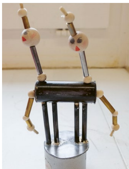
Metall-Drückfiguren wurden erdacht und sind erprobt als vertiefende Einstiegsarbeit im Bereich der Metallbearbeitung.
