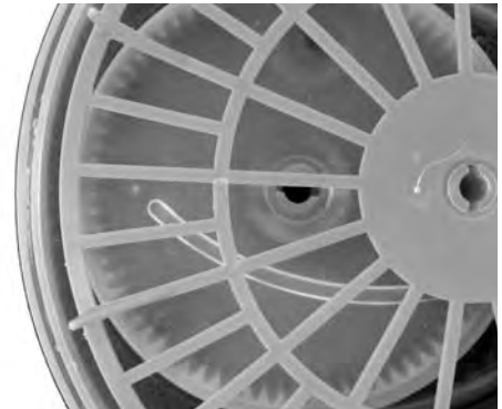
Planetengetriebe einer Salatschleuder
