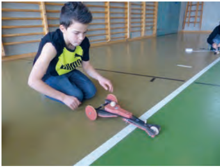
Dieser Gummi-Flitzer fährt mit einem Gummizug mit 3-mm-Durchmesser über 30 Meter.
