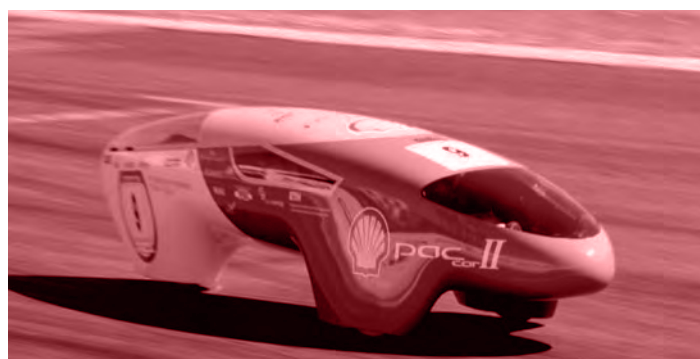
Dank konsequentem Leichtbau und modernster Technologie fuhr der von ETH-Studierenden entwickelte PAC-Car II mit einem Liter Benzin über 5000 km weit. (Quelle: ETH Zürich)
