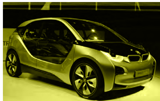
Modernes Leichtbau-Fahrzeug, das seit 2013 in Serie hergestellt wird : BMW i3 mit Elektroantrieb und Fahrgastzelle aus leichtem und steifem Carbon. (Foto: BMW)
