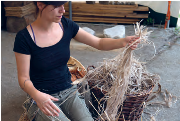
Für die Herstellung eines Seils fasst man ein Bündel Bast und kämmt die Fasern, damit alle etwa in die gleiche Richtung schauen.
