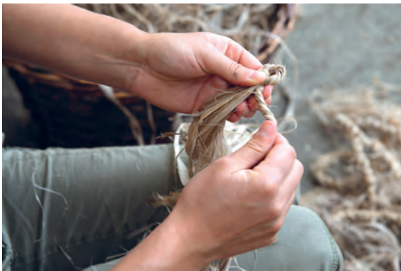
Mit der rechten Hand dreht man das hintere Ende zwei- bis viermal ...
