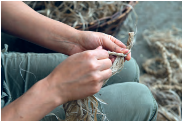
So zwirnt man weiter, bis das Seil die gewünschte Länge hat.
