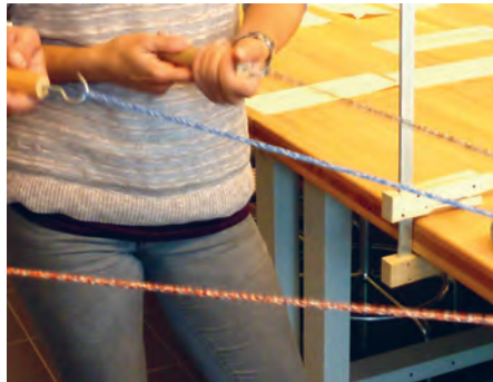
Pro Farbe werden mindestens drei Schnüre abgemessen – je mehr Schnüre, umso dicker wird das Seil.
