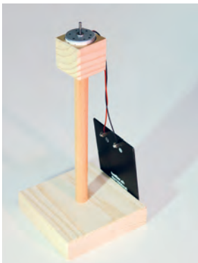
Einbau des Motors in die Säule
