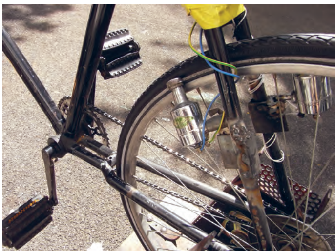
Der Dynamo wird entweder mit Schrauben befestigt oder direkt angeschweisst.
