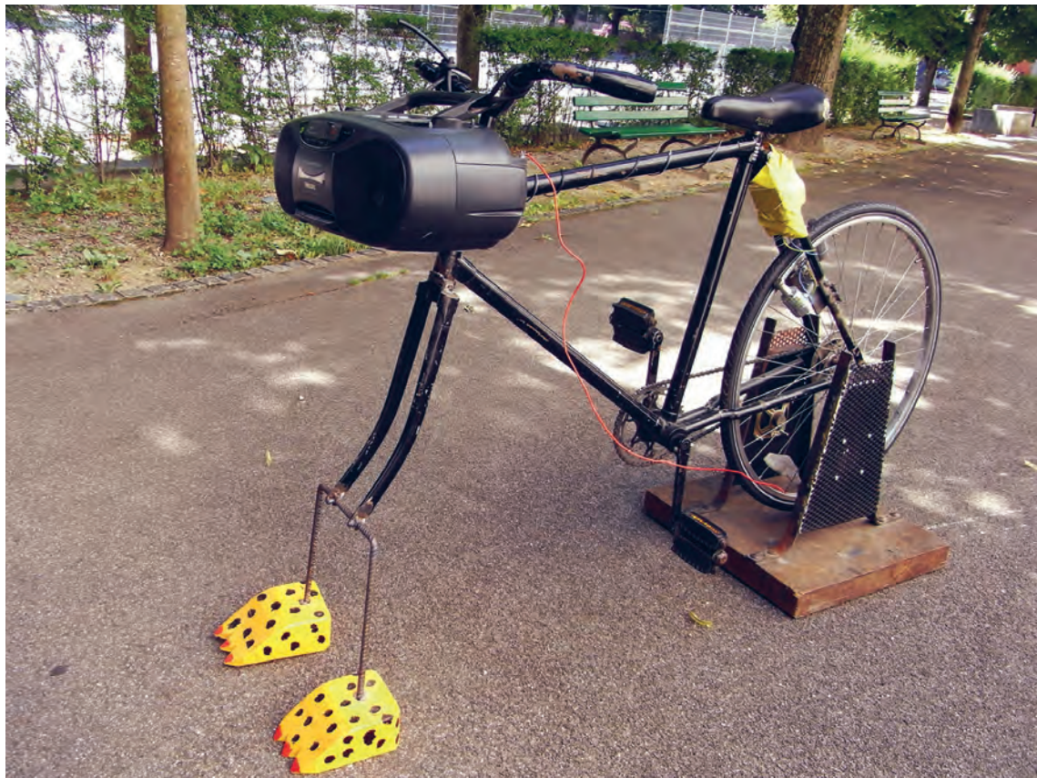
Anstelle des Vorderrads sind auch Holzfüsse geeignet. Die Elektronik steckt unter dem Sattel und muss gegen Kurzschlüsse isoliert werden.
