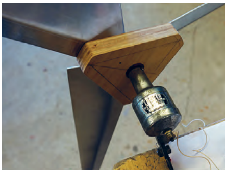
Nabe: Montage der Flügel am Dynamo
