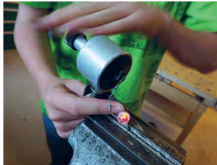
Dynamotest: LED mit Widerstand anschliessen.
