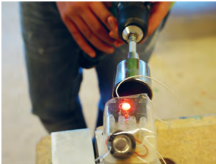
Test Kondensator: Wie lange leuchtet die LED?
