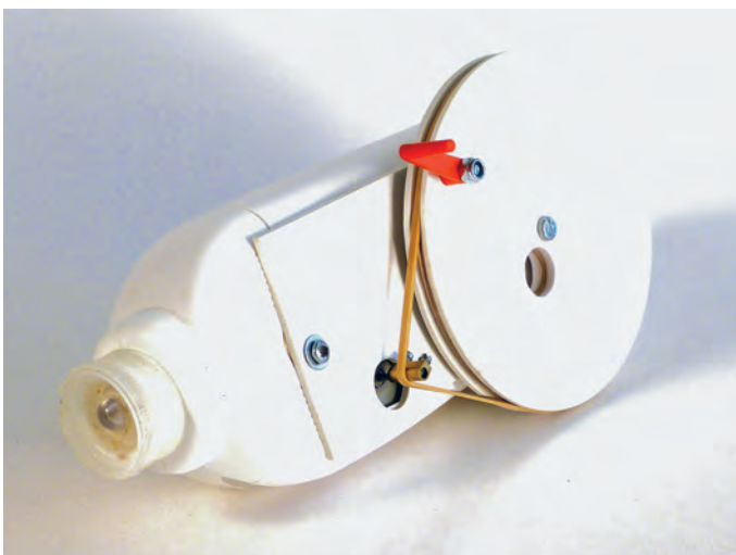
Die Taschenlampen im Recyclingobjekt nutzen einen Elektrolyt-Kondensator als Speicher – dessen sofortige Entladung wird durch eine zusätzliche Diode verhindert.
