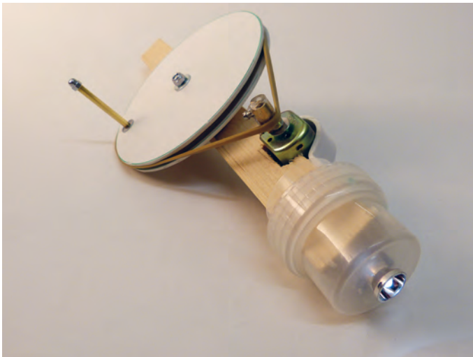
Übersetzung des Handantriebs über eine Riemenscheibe – links die Lampe ohne Gehäuse, rechts verpackt im massiven Buchengehäuse.
