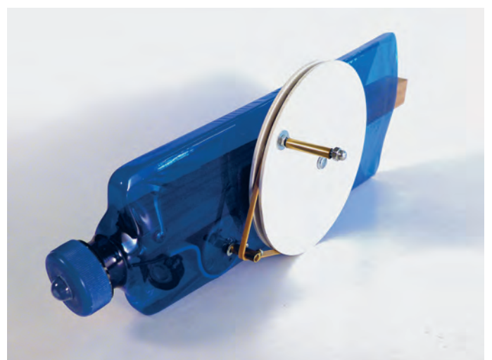
Die Taschenlampen im Recyclingobjekt nutzen einen Elektrolyt-Kondensator als Speicher – dessen sofortige Entladung wird durch eine zusätzliche Diode verhindert.
