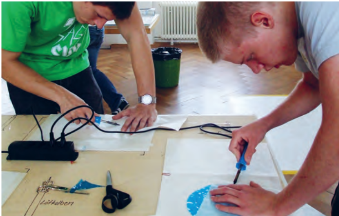
Plastiksäcke mit Lötcolben oder mit dem Bügeleisen verschweissen
