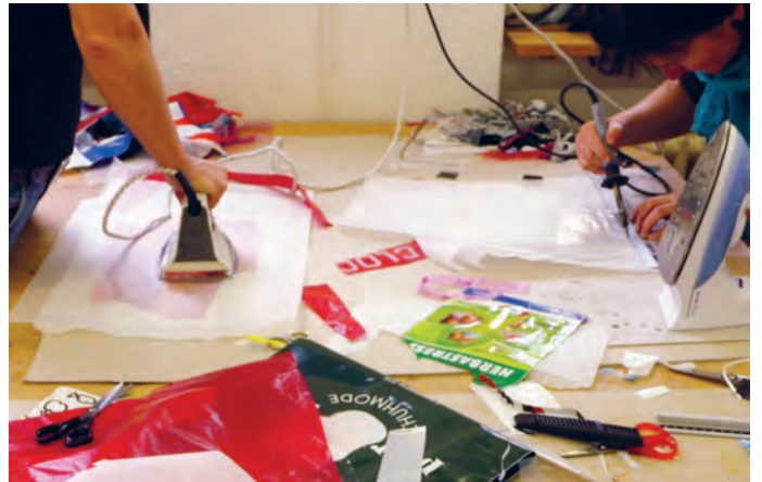
Plastiksäcke mit Lötcolben oder mit dem Bügeleisen verschweissen
