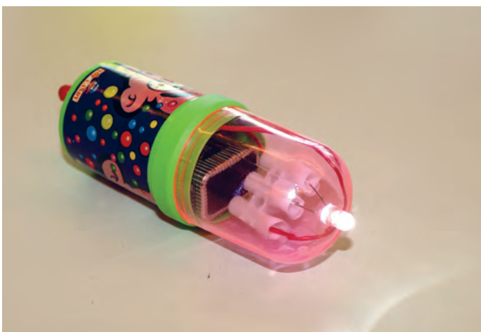
9V-Batterie mit Vorwiderstand als platzsparende Lösung
