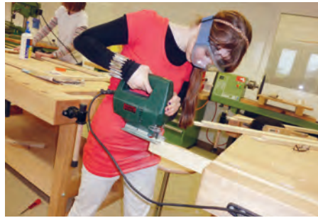
Zusägen der Doppellatten mit der Stichsäge
