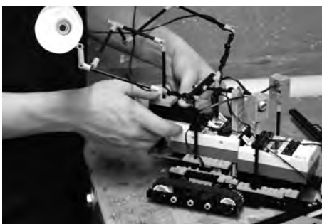
Wahrnehmung über Tast-, Sound- und Lichtsensoren
