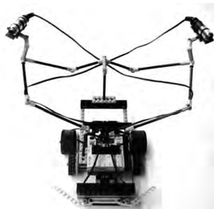
Roboter nimmt seine Umgebung über ein Tast- und Soundsensorpaar wahr.
