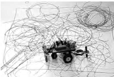
Zeichenroboter verursacht Zeichenspuren und versucht diese zu erkennen, um darauf zu reagieren.
