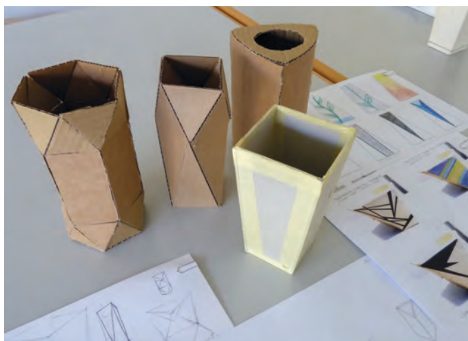
Die Funktionsmodelle aus Karton werden mehrmals angepasst, bevor sie in Plattentechnik umgesetzt werden.
