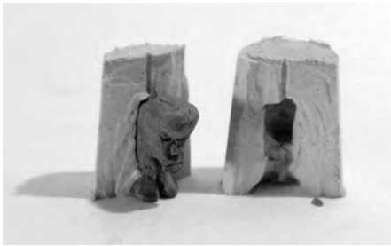
Für die Abformung wird ein Plastikbecher am Boden aufgeschnitten, abgedichtet und mit Silikon gefüllt. Aus der aufgeschnittenen Negativ-Form entsteht in einem neuen Becher die Silikon-Form mit Einguss und Entlüftung. Am Gussrohling sind die Gusskanäle noch sichtbar.
