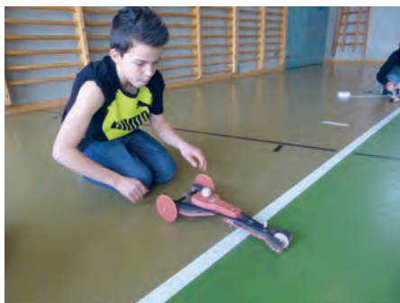
Dieser Gummi-Flitzer fährt mit einem Gummizug mit 3-mm-Durchmesser über 30 Meter.
