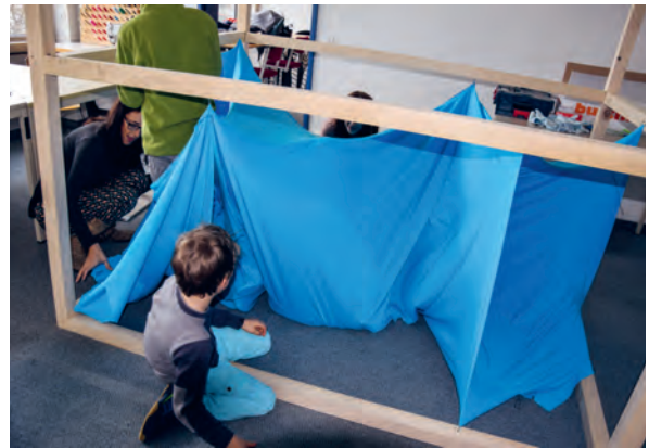
Bau eines Prototyps zur Erprobung der Dehnbarkeit des Stoffes.
