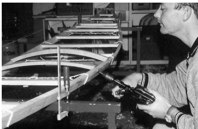
Die Decksbalken werden mit selbst geschnitzten Holzdübeln in den Balkweger verzapft.
